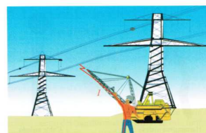
Figura 21.9. Contacto directo por descarga disruptiva.
