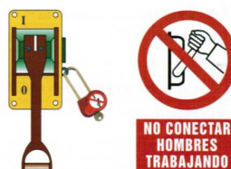
Figura 21.32. Ejemplo de sistemas de enclavamiento y señal de prohibido maniobrar.
