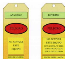
Figura 21.33. Señales de prohibido maniobrar aparatos de corte.
